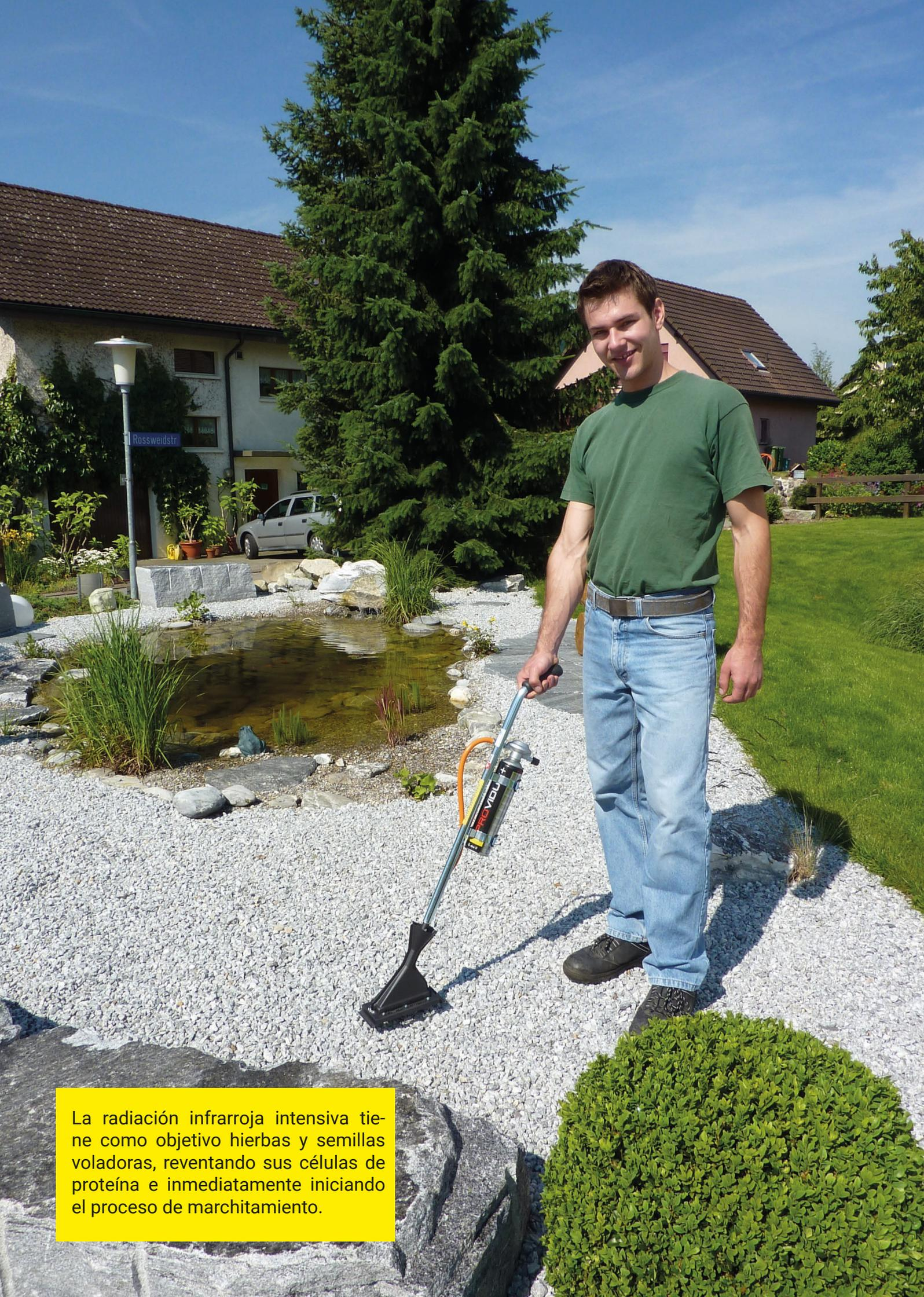
La radiación infrarroja intensiva tiene como objetivo hierbas y semillas voladoras, reventando sus células de proteína e inmediatamente iniciando el proceso de marchitamiento.
